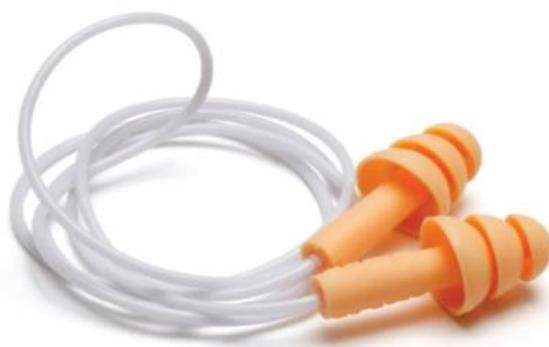
DESCRIÇÃO TÉCNICA: O Protetor Auditivo do tipo inserção (plug) é confeccionado em silicone e possui formato cônico com três flanges macias e cônicas. De tamanho único, reutilizável e com cordão de silicone, o protetor é moldável e de material maleável, podendo ser aplicado a diferentes canais auditivos. Indicado para exposição a níveis de ruído acima de 85 dB(A).
