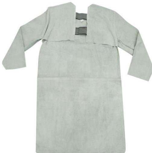
DESCRIÇÃO TÉCNICA: Avental com mangas do tipo barbeiro (soldador) com emendas é confeccionado em raspa de couro bovino curtido ao cromo, costurado com fio 100% algodão ou aramida. Possui tiras laterais em raspa, indicadas para fixação e ajuste do avental, com elásticos de ajustes no cano da manga, proporcionando segurança e facilidade de uso. Indicado para uso em atividades que envolvam riscos ao usuário quanto à abrasão e escoriações.
